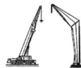
Esempi di gru mobili su ruote con falcone telescopico o brandeggiabile
