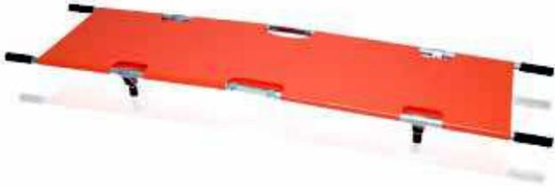
Realizzata in alluminio anticorrosivo anodizzato con telo in poliestere alta tenacità spalmato in PVC antiputrescente, autoestinguento, lavabile. Piedini di sostegno in alluminio, snodi con l'esclusivo NCF system in ferro zincato che ne permettono un uso sicuro ed affidabile anche per operatori inesperti. Sottoposta a prove di laboratorio secondo le specifiche previste dalle norme DIN 13124. Fornita con istruzioni per l'uso.
