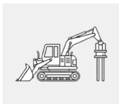
esempio di terna con attrezzatura per la posa dei pali
